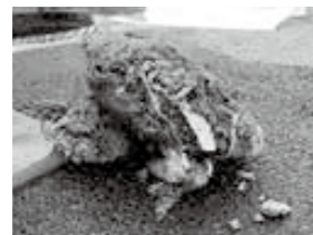
詰まった下水道管から出た油や髪の毛の塊
