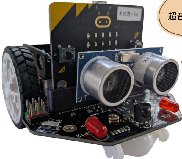
ロボットカー：micro:Maqueen（マイクロマクイーン）
